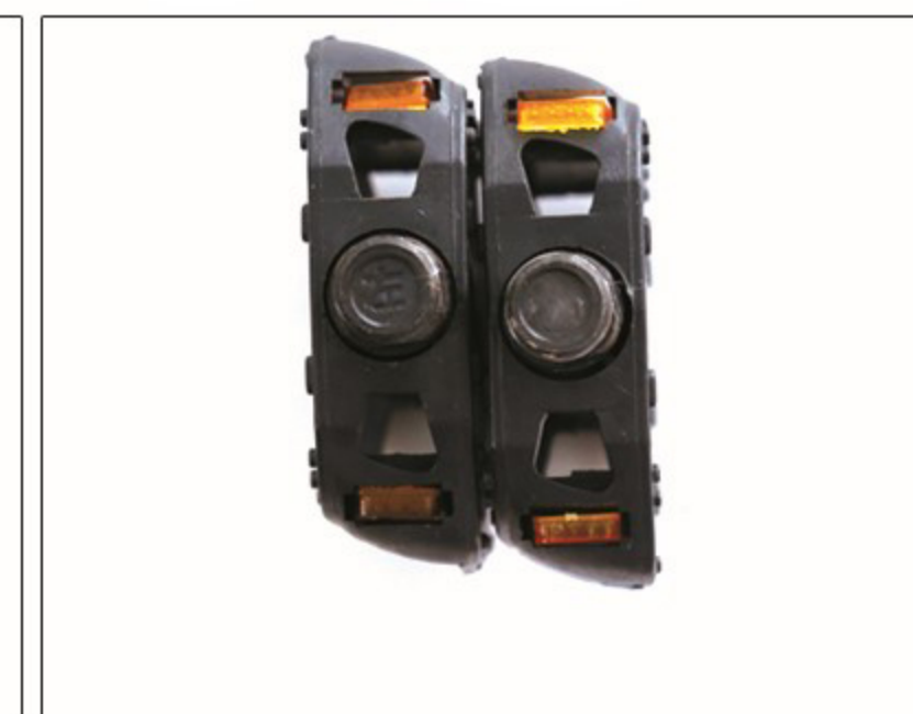
17. Let op je hebt een linker en een rechter trapper, draai deze erop tot dat het schroefdraad niet meer zichtbaar is. Vast is vast.
