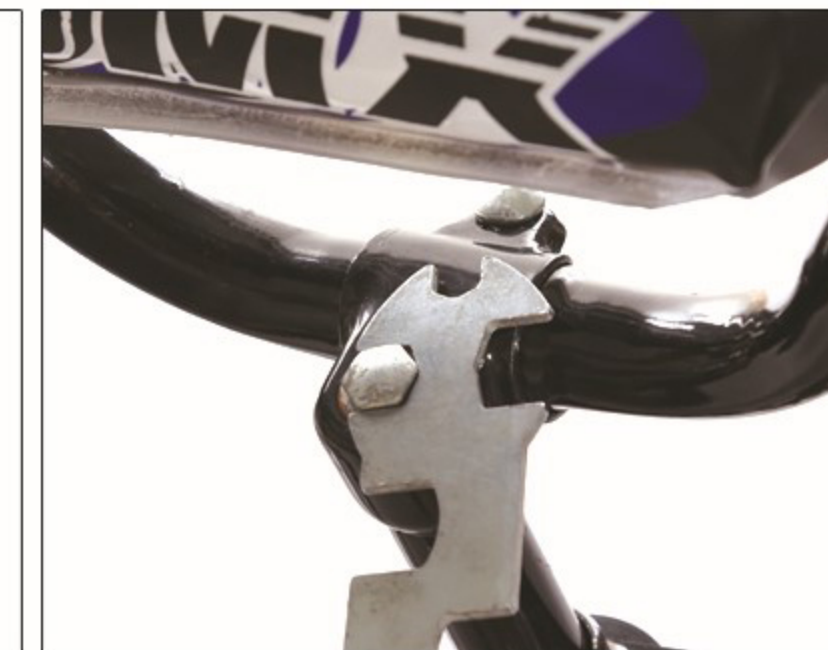
13. Steek de stuurpen in het frame en draai daarna de bout geleidelijk aan tot dat het stuur vast zit.
