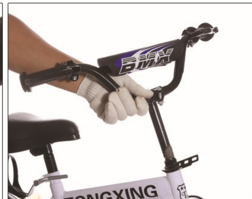
13. Steek de stuurpen in het frame en draai daarna de bout geleidelijk aan tot dat het stuur vast zit.
