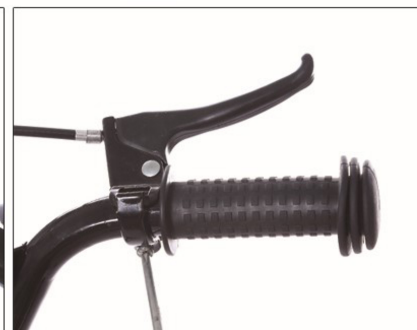
16. Bevestig de remkabel aan de handrem.
