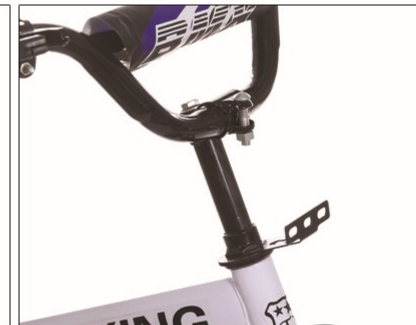
13. Steek de stuurpen in het frame en draai daarna de bout geleidelijk aan tot dat het stuur vast zit.
