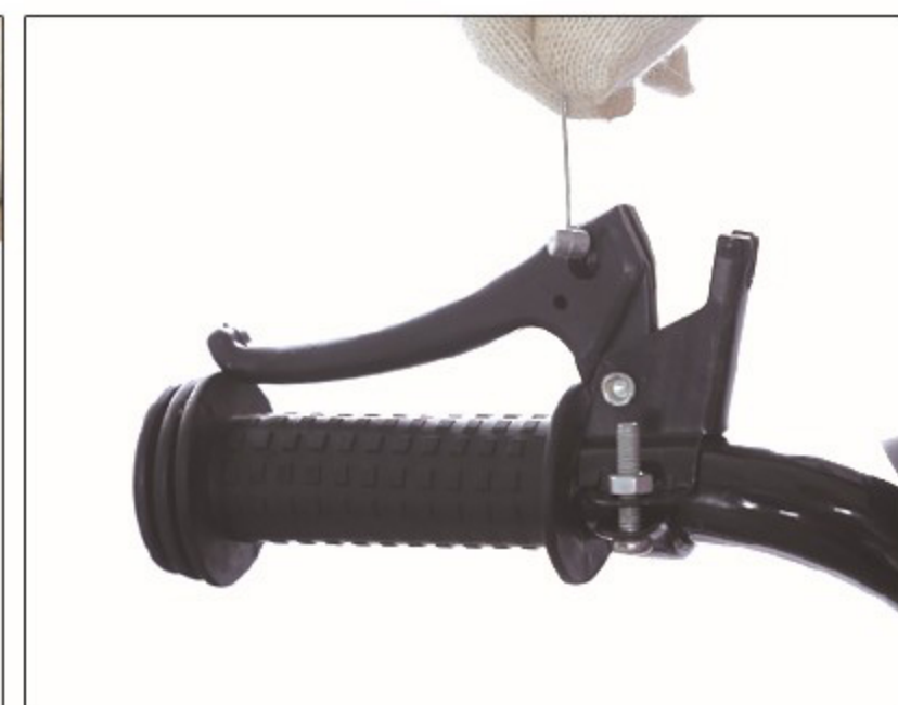
16. Bevestig de remkabel aan de handrem.
