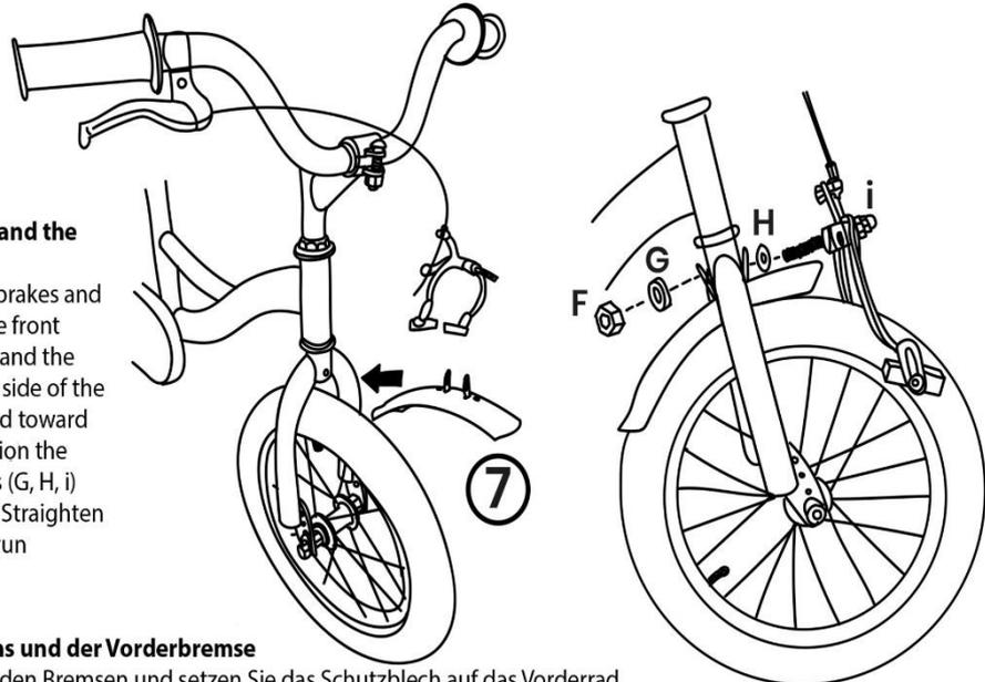
**Montage des Schutzblechs und der Vorderbremse**
